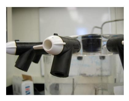
10)Turn on vacuum (MAKE SURE THAT THE CONDENSER IS AT -40°C OR LOWER BEFORE YOU TURN ON THE VACUUM)
